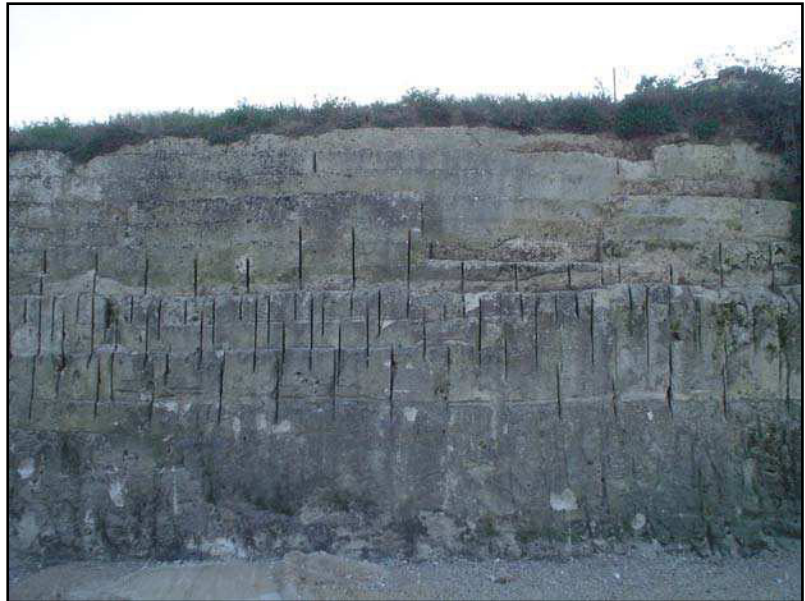
Foto 5.11 – Cava di tufo a N di Matera lungo la direttrice Matera - Altamura. Sono visibili le tracce delle incisioni della sega da roccia per la separazione in blocchetti dalla forma prevalente a parallelepipedo.
